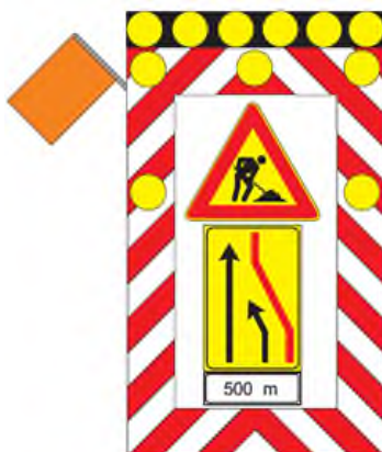
Figura 12: "segnale mobile di preavviso" fig. Il 400 Art.39 Reg. da impiegare su tratti autostradali con corsia di emergenza per la chiusura di una o più corsie di transito (la figura esemplifica la chiusura della corsia di marcia in dx). E' integrato con set di 6 lampade a led ad alta efficienza luminosa diam. 300 mm (con possibilità di lampeggio sincrono e sequenziale) e con sbandiatore elettromeccanico posto in alto sul lato esposto al traffico.
