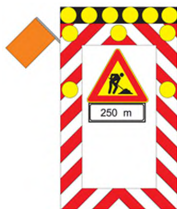
Figura 14: "segnale mobile di preavviso" derivato dalla fig. Il 400 Art.39 Reg. da impiegare per lavori sulla sola corsia di emergenza. E' integrato con set di 6 lampade a led ad alta efficienza luminosa diam. 300 mm (con possibilità di lampeggio sincrono e sequenziale) e con sbandiatore elettromeccanico posto in alto sul lato esposto al traffico.
