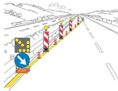
TESTATA DI RIDUZIONE PER CANTIERE SUPERIORE A 7 GIORNI
